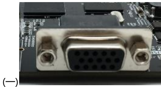
图 3-4-3 VGA 接口实物图
