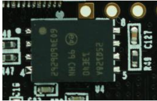
图 2-5-2 QSPI FLASH 部分实物图
