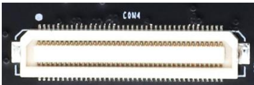
图 2-10-4 CON4 扩展口连接器的实物图
