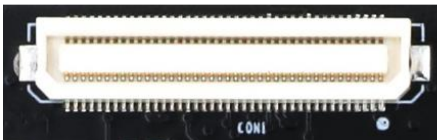
图 2-10-1 CON1 扩展口连接器的实物图
