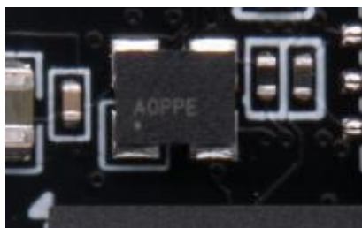
图 2-5-2 33.333333Mhz 有源晶振实物图
