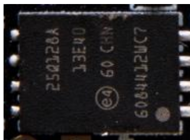
图 2-5-2 QSPI FLASH 部分实物图
