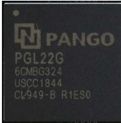
图 2-2-1 FPGA 芯片实物
