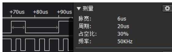
如上图，鼠标放在最上面通道的一个正脉冲位置上，这个脉冲和相邻的下一个负脉冲位置上就会出现箭头指示，右侧测量窗口内就会显示当前这个正脉冲的宽度为 6us，整个周期为 20us，此一周期内的占空比为 30%，此一周期对应的频率为 50kHz。
