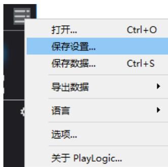
在随后弹出的保存文件对话框中选择好路径和文件名，点击“保存”即可。软件会将包括通道设置、协议解析器设置等内容都保存到该文件中。日后需要使用同样设置时，只需通过点击主菜单中的“打开...”，在随后弹出的打开文件对话框中找到该文件，打开即可。
