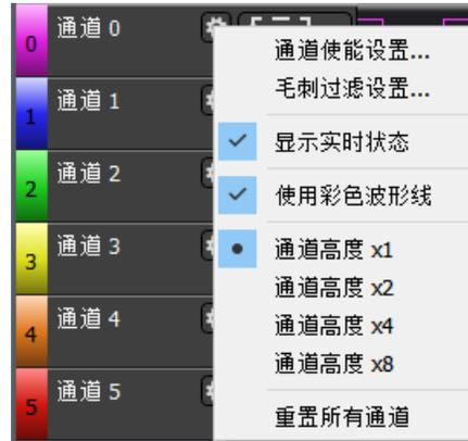
具体效果如下图所示：当通道上有电平的跳变时，绿灯点亮；当通道上电平无变化时，低电平显示为数字“0”，高电平显示为数字“1”；当设备未连接时则不显示任何信息。
