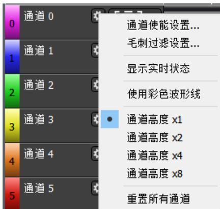
使用菜单中的“通道使能设置”，也可以在设置框内使能或关闭相应的通道。
