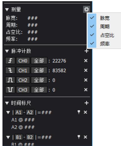
选定某些功能后，将鼠标移动到波形显示窗口内，此时测量窗口内将显示鼠标当前位置相关参数的测量结果。
